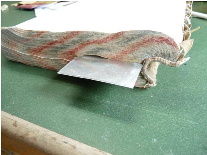
Am innersten Punkt der Rückenrundung wird ein dünnes Blech in den Buchblock gelegt. Mit dessen Hilfe lässt sich die Form mit den Händen etwas korrigieren und der Band in die Presse setzen.
