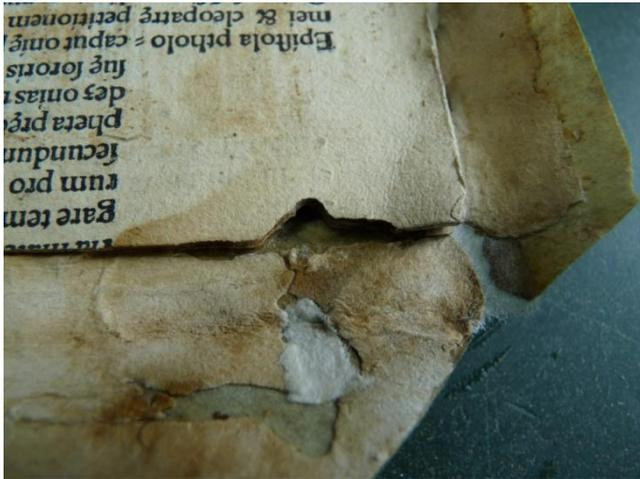
Kleinere Fehlstellen (hier durch Anobienfraß entstanden), die nicht stark beansprucht werden, werden mit Cellulosefasern, Kleister und Thylose ausgekittet.
