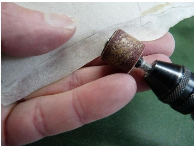
Die überlappenden Ränder werden zuerst ausgeschliffen und anschließend mit dem Skalpell weiter ausgedünnt und dem Original angepasst.
